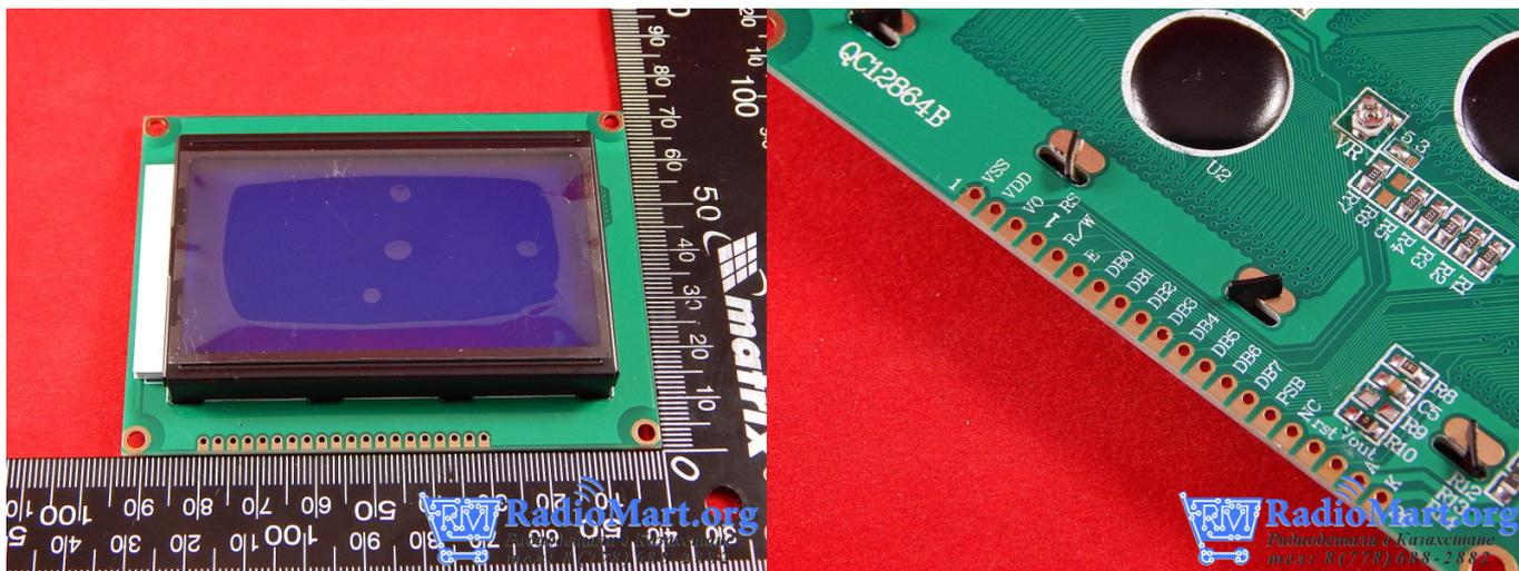
Монохромный синий жидкокристаллический экран с разрешением 128×64
