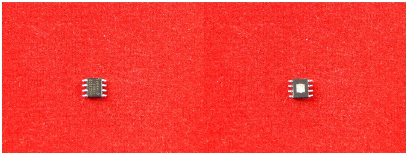
Стабилизатор линейного напряжения на 5V.
