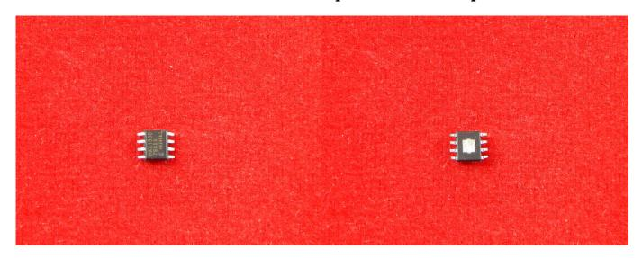
Стабилизатор линейного напряжения на 5V.
