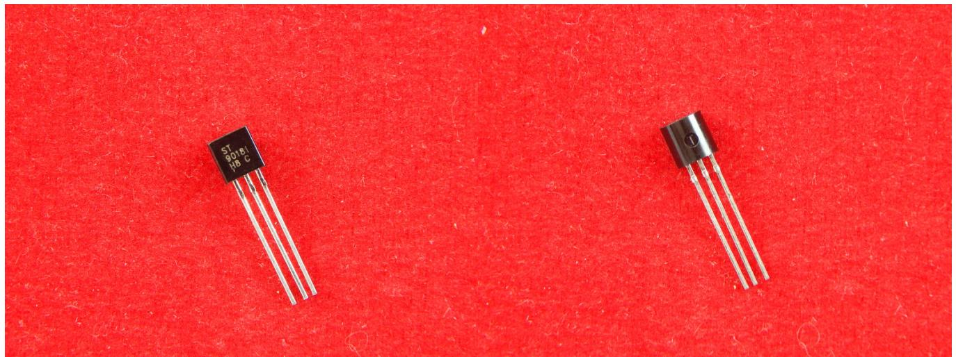
Транзисторы SS9018(S9018) - кремниевые, сверхвысокочастотные усиительные, структуры - п-п-н.
