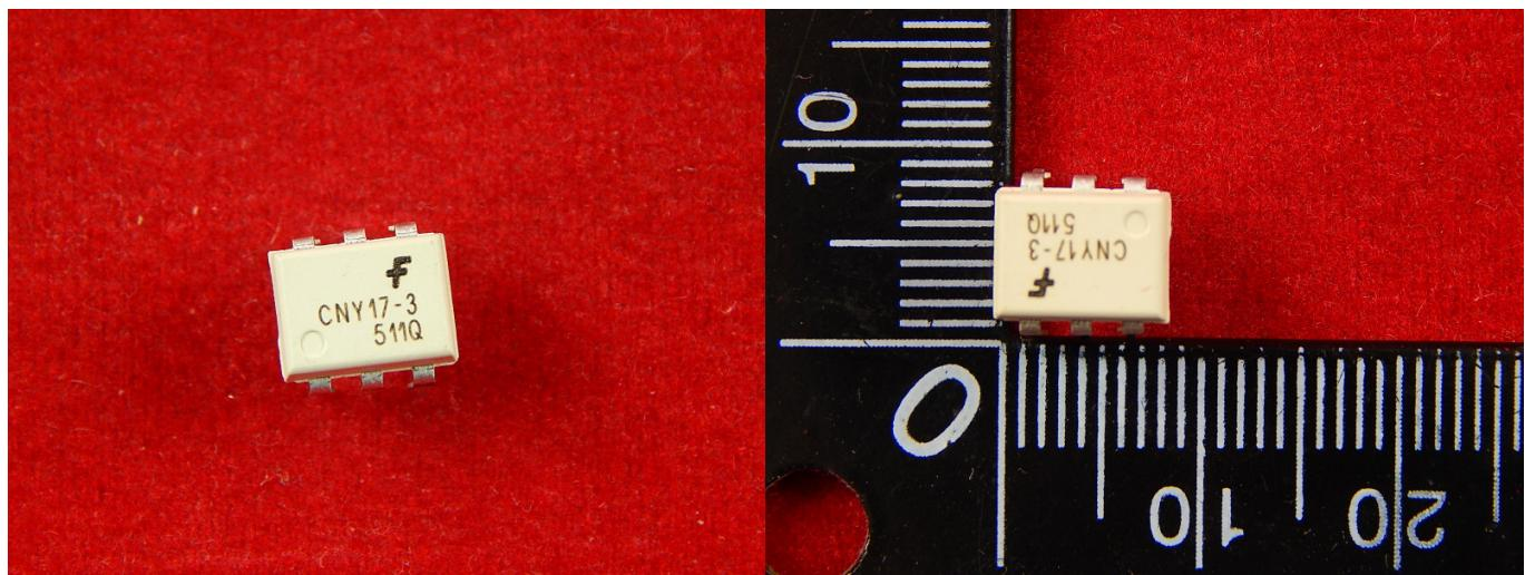
Оптопара транзисторная CNY17-3 с высоким выходным напряжением пробоя, с транзисторным выходом. Предназначена для использования в качестве переключателя в гальванически развязанных электрических цепях радиоэлектронной аппаратуры.
