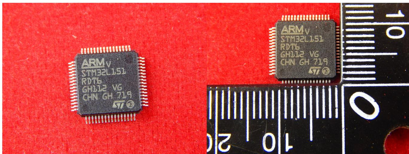
Микроконтроллер ARM Cortex-M3 со сверхнизким энергопотреблением со вспышкой 384 Кбайт, 32 МГц процессором. Микроконтроллер сочетает в себе очень высокую производительность, возможности в реальном времени выполнять цифровую обработку сигналов и при этом имеет низкое энергопотребление.
