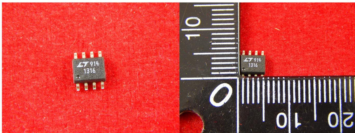
LT1316 представляет собой повышающий микропроцессор DC/DC преобразователь, который работает от входного напряжения всего 1,5 В. Программируемая функция ограничения входного тока позволяет точно контролировать пиковый ток переключения.
