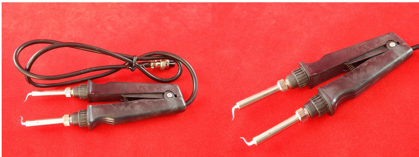
Термопинцет мощностью 24В/ 60Вт с пластиковой ручкой. Оснащен керамическим нагревательным элементом жалом. Предназначен для монтажа компонентов на печатные платы и демонтажа крупных компонентов нечувствительных к статическому электричеству.
