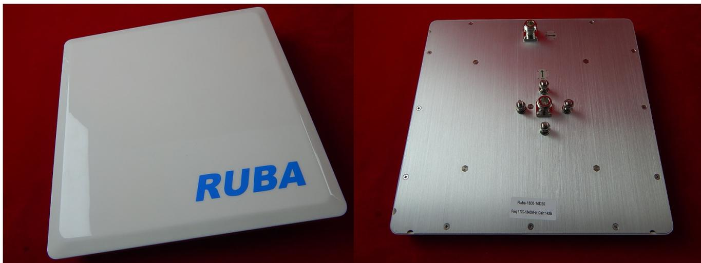
Ruba LTE14D30 - антенна для Altel 4G. Данная модель имеет коэффициент усиления 14 dBi и работает в частотном диапазоне 1770-1840 МГц. Панельная Lte антенна имеет двойную линейную поляризацию, вертикальную и горизонтальную, что значительно улучшает уровень и стабильность приема сигнала, как следствие скорость и качество работы интернета.
