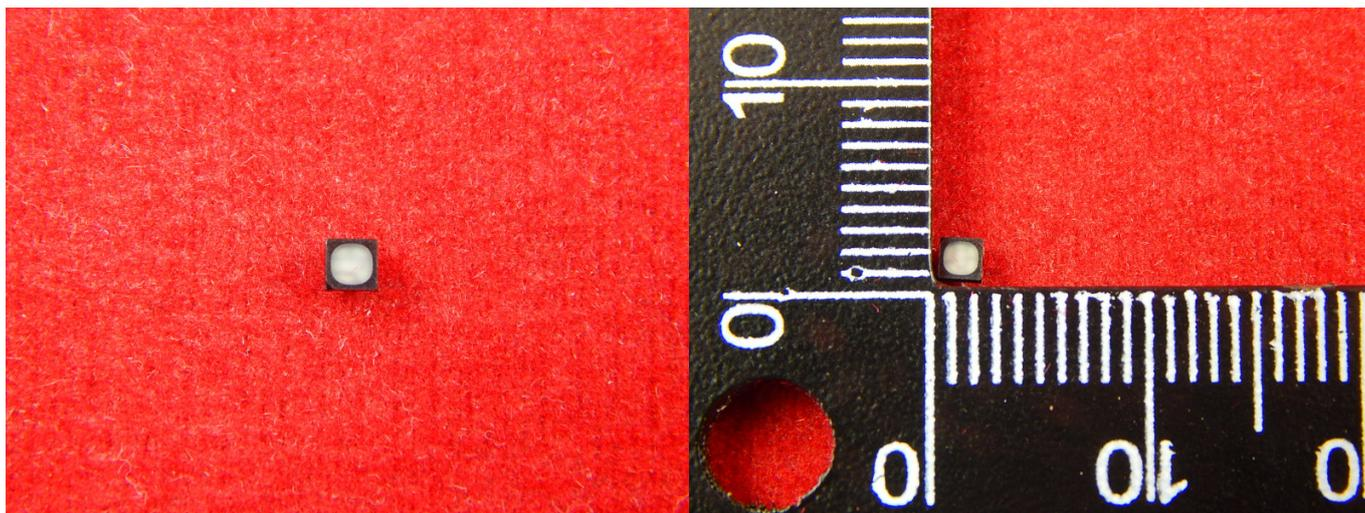
Светодиод — это полупроводниковый прибор, преобразующий электрический ток непосредственно в световое излучение. Светодиод для поверхностного монтажа (2121 SMD LED).
