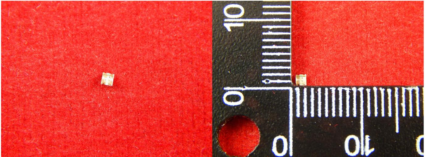
Светодиод — это полупроводниковый прибор, преобразующий электрический ток непосредственно в световое излучение. Светодиод для поверхностного монтажа (1615 SMD LED).
