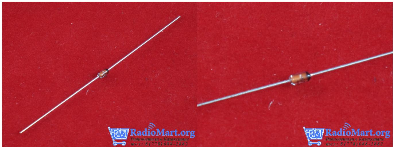
Кремниевый диод 1N4148 обладает следующими параметрами: прямой ток -- не менее 150mA, обратное напряжение 100В и высокая скорость переключения -- не более 4 нс. Эти параметры, а также дешевизна и относительно небольшой корпус DO-35 позволили стать ему одним из самых распространенных диодов.
