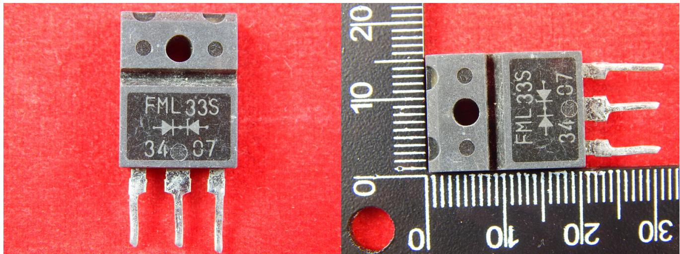
Диод – двухэлектродный полупроводниковый прибор с одним р-п-переходом, обладающий односторонней проводимостью тока. Данный диод предназначен для преобразования переменного напряжения с максимальным допустимым средним прямым током 20 А.
