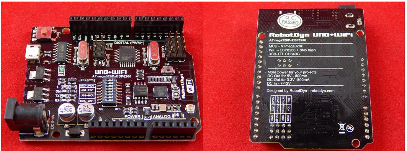
Плата с микроконтроллером ATmega328P + интегрированный в схмотехнику контроллер ESP8266 (WiFi). Также плата оснащена преобразователем интерфейса USB-UART (CH340G), 14 цифровыми входами/выходами (6 из которых могут быть использованы, как PWM-выходы), 6 аналоговыми входами, 16 МГц кварцевым генератором, USB micro B портом, разъёмом питания, контактными площадками ICSP и кнопкой Перезагрузка.
