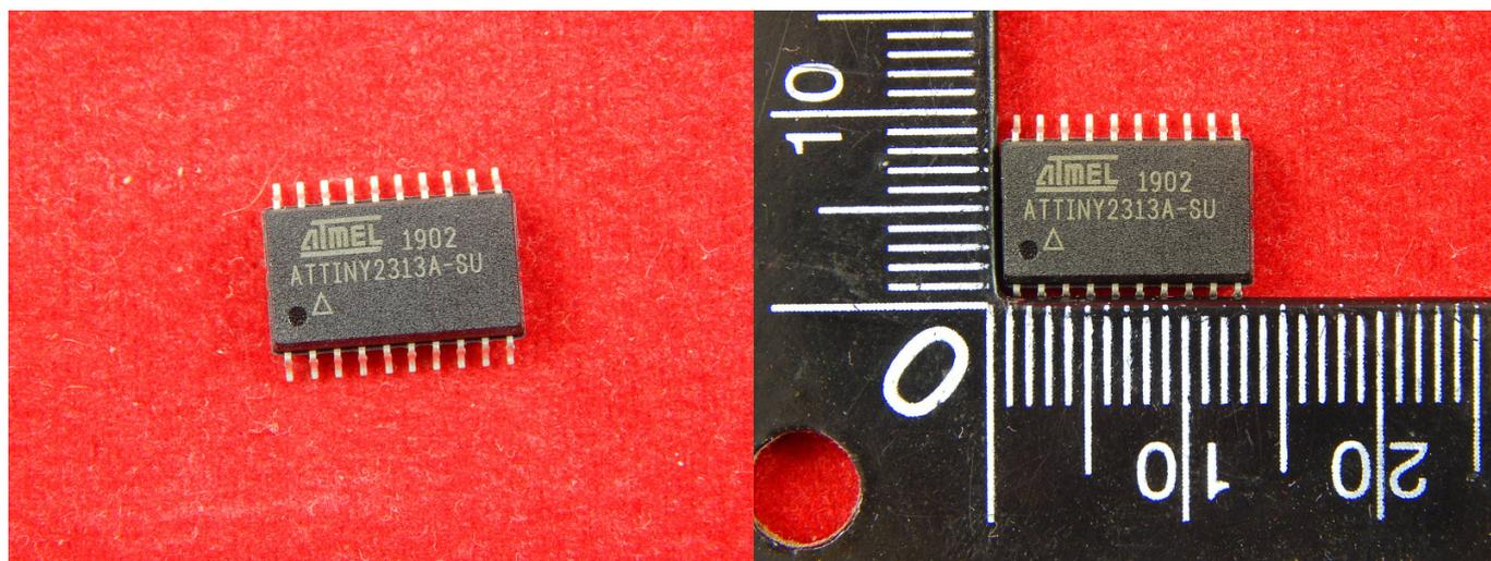
ATtiny2313A - экономичный 8-битный КМОП-микроконтроллер, выполненный на основе улучшенной RISC архитектуре - AVR. За счет выполнения большинства инструкций, за один цикл синхронизации ATtiny2313A достигает производительности близкой к 1 млн. оп. в сек. на каждый МГц тактовой частоты, тем самым позволяя разработчику систем оптимизировать соотношение энергопотребления и производительности.
