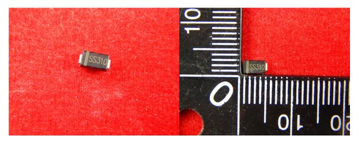
SS310 является выпрямительным диодом Шоттки с лужеными клеммами, пластиковым корпусом и индикацией катода и полярности.
