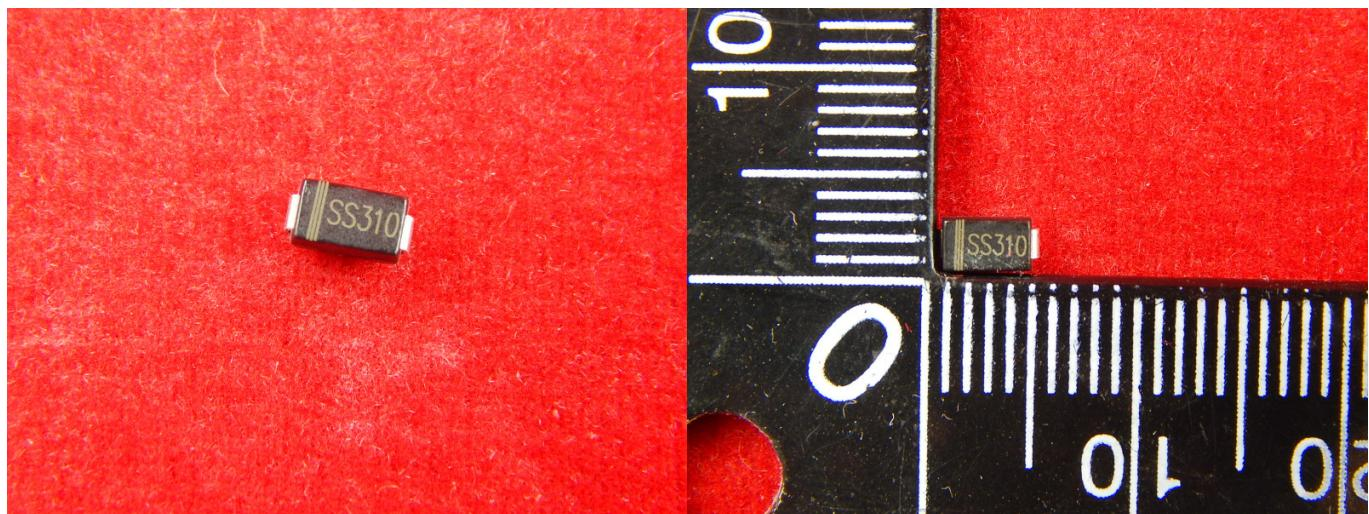
SS310 является выпрямительным диодом Шоттки с лужеными клеммами, пластиковым корпусом и индикацией катода и полярности.
