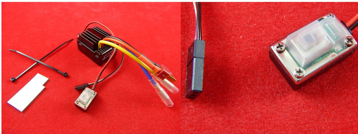
Электронный регулятор хода для коллекторных двигателей. Позволяет регулировать обороты двигателя с потреблением тока до 180А. Работает от Li-xx и Ni-xx аккумуляторов.
