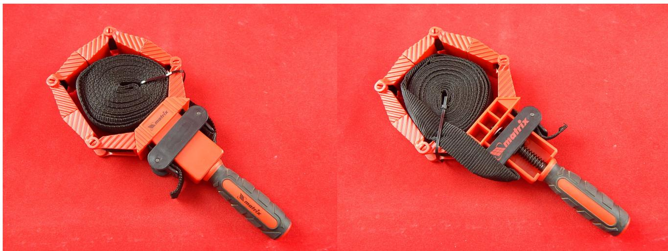
Струбцина – это вспомогательный инструмент, который применяется для закрепления деталей путем прижатия между собой или к требуемой поверхности. Они широко используются столярами и сварщиками. Обычно инструмент состоит из двух частей – рамки и зажимного механизма.
