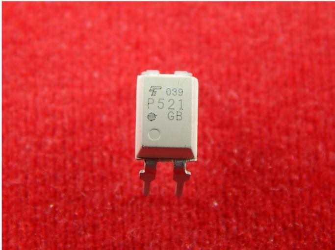
TLP521-1 - Оптопара или оптрон — электронный прибор, состоящий из излучателя света и фотоприёмника, связанных оптическим каналом и объединённых в общем корпусе.
