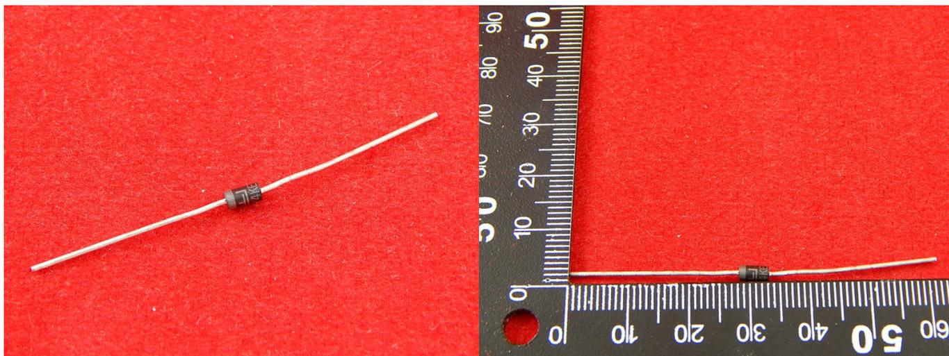
Диод — это электронный элемент, обладающий нелинейной вольт-амперной характеристикой. Электроды диода носят названия анод и катод.
