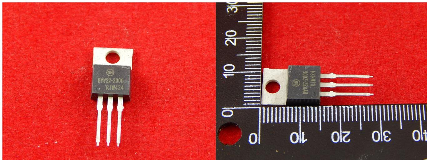
Выпрямительные диоды — это диоды, используемые для преобразования переменного тока в постоянный. На смену электровакуумным диодам и игнитронам пришли диоды из полупроводниковых материалов и диодные мосты.
