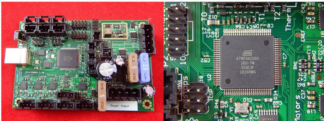
Плата управления Mini-Rambo - это более компактная версия платы электроники управления RAMBo, которая используется для управления многими 3D-принтерами на основе RepRap. Разработанная производителем оригинальной электроники RAMBo и RAMPS, плата электроники для 3D-принтеров Mini-Rambo объединяет Arduino MEGA и 4 шаговых драйвера в крошечную упаковку.
