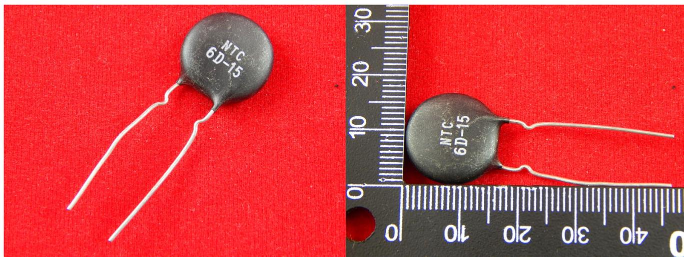
NTC термисторы - полупроводниковые приборы, электрическое сопротивление которых изменяется в зависимости от температуры.
