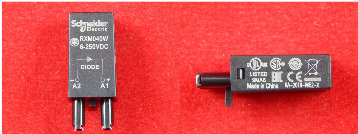
Предназначен для защиты катушек реле RXM, рассчитанных на напряжение постоянного тока от возможного подключения напряжения переменного тока. Диапазон напряжений: 6—250 В. Используется с розетками серии RXM.
