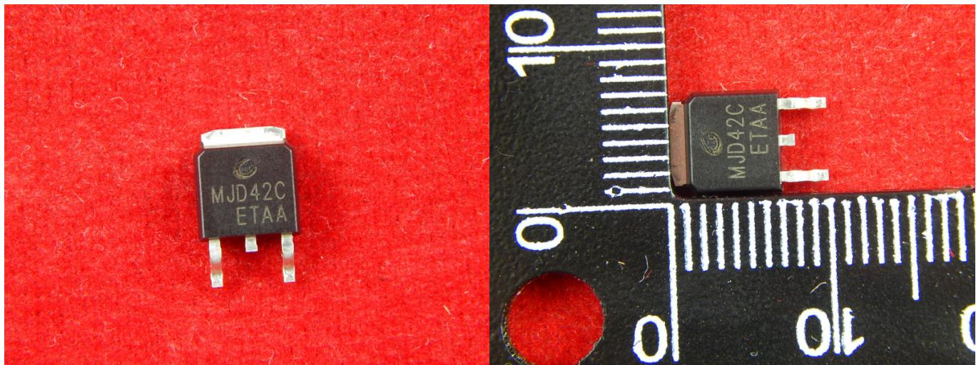
Биполярный силовой транзистор предназначен для применения в усилителях общего назначения и коммутации на низких скоростях. MJD42C это биполярный силовой транзистор 6A, 100V PNP типа.
