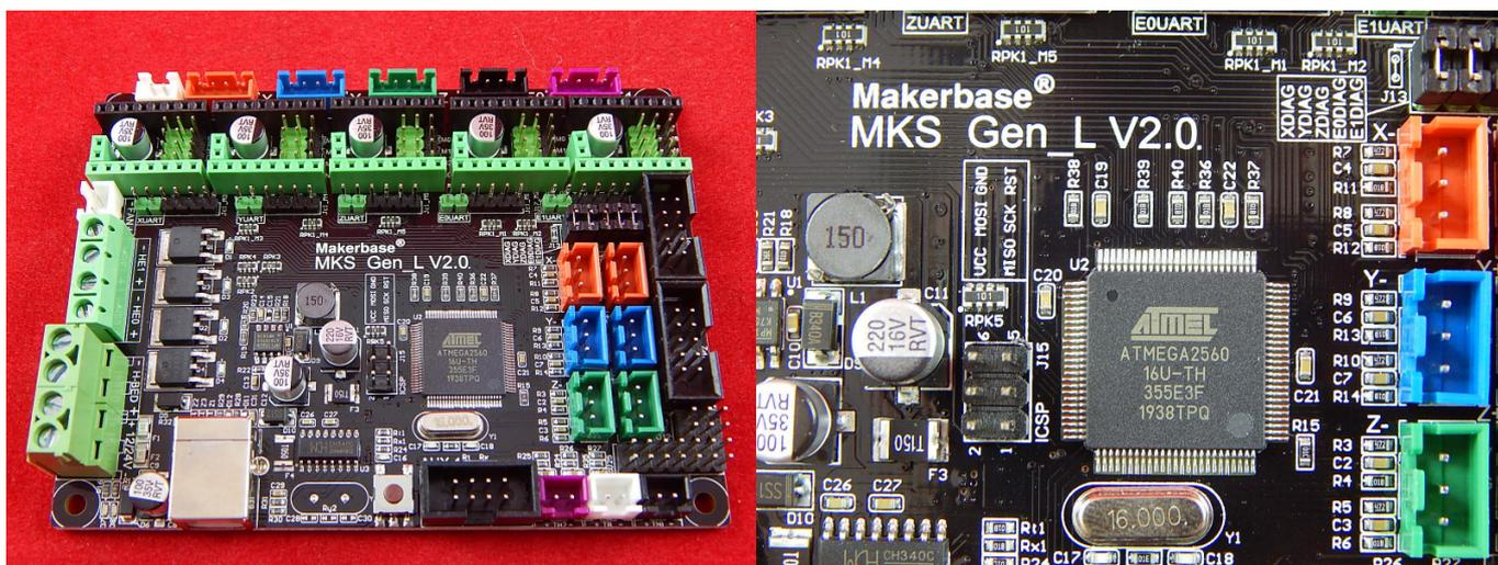
MKS Gen-L v2.0 - новая улучшенная материнская плата для 3D принтера. По сравнению с V1.0, V2.0 можно легко включать ТМС шаговый Драйвер переключателями. Нет необходимости в проводке кабеля. Такие имеет: TMC2130 SPI режим, TMC2208/2209 UART режим.
