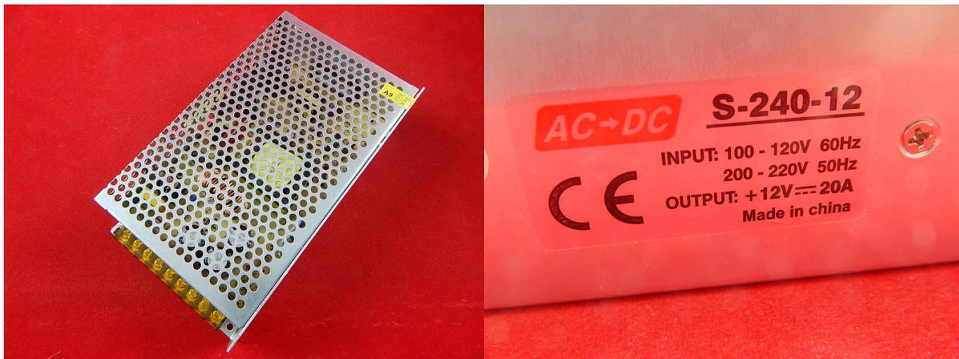
Блок питания 12В 20А 240Вт (S-240-12) - импульсный блок питания. Имеет пассивную систему охлаждения. БП защищен от короткого замыкания, перенапряжения, перегрузок и высокой температуры.
