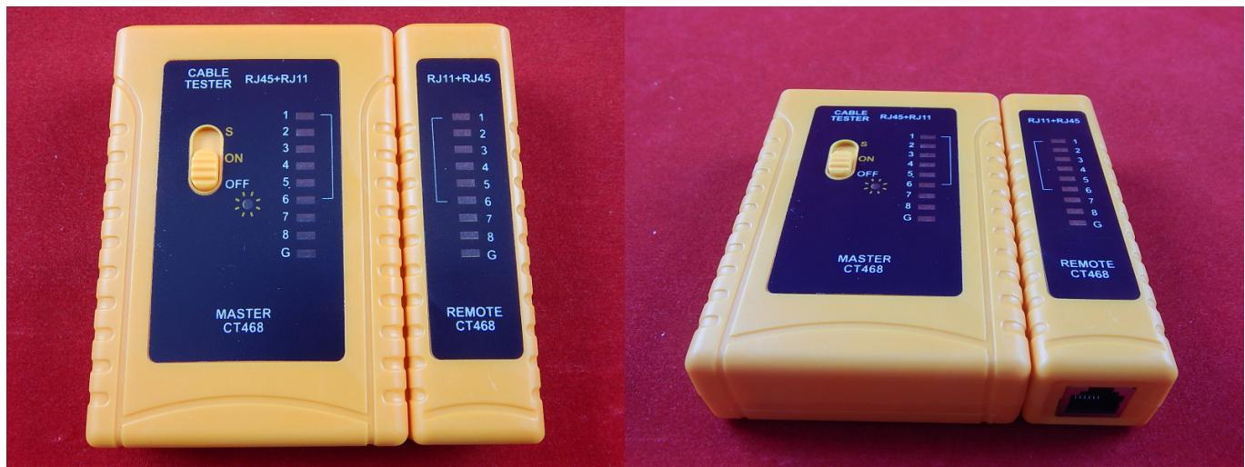
Тестер предназначен для одновременной проверки целостности проводов и соединений в кабелях с витыми парами числом проводов до восьми, в том числе экранированных. Тестер кабеля состоит из двух функциональных блоков - передатчика и приемника, которые подключаются к концам кабельной линии через разъемы RJ-45/RJ-11/RJ-12. Светодиодная индикация есть на основном блоке прибора и на удаленном модуле.
