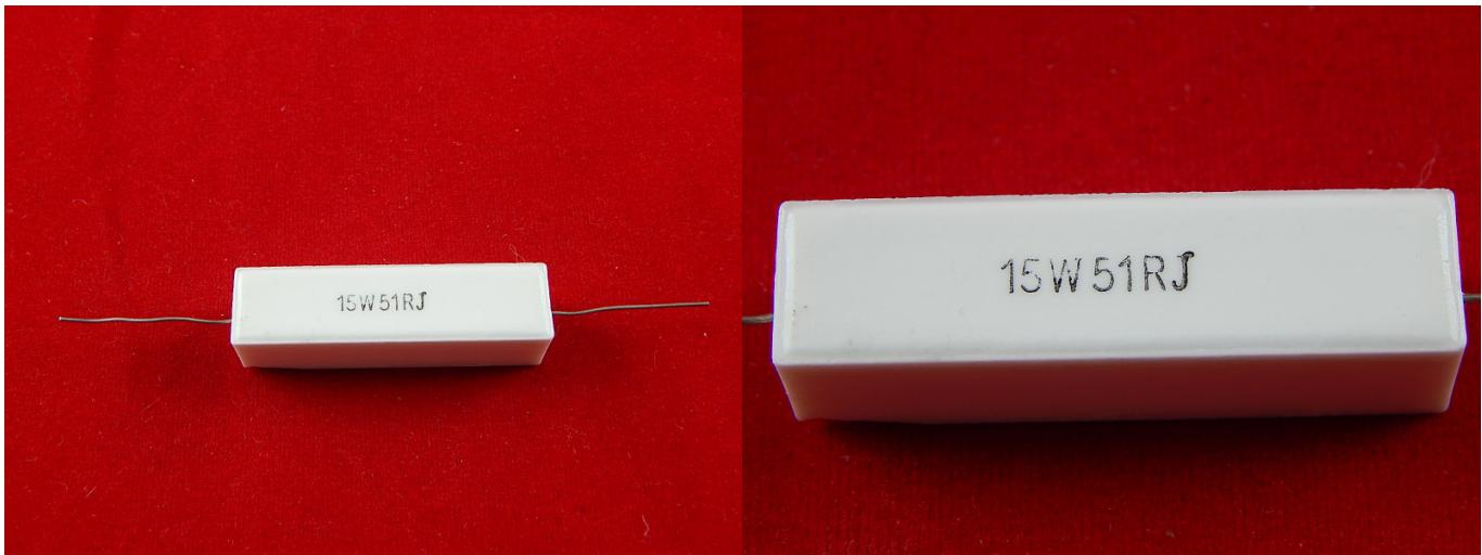
Резисторы керамические проволочные цементные – постоянные резисторы, номинальное сопротивление составляет 51 Ом, рассеиваемая мощность – 15Вт. Предназначены для эксплуатации в цепях постоянного или переменного тока, обеспечивая ограничение силы тока и распределение напряжения. Монолитная керамическая конструкция обладает: огнестойкостью, влагостойкостью и способностью к самозатуханию.
