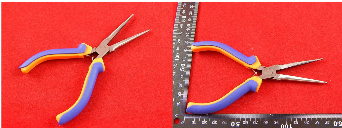
Длинногубцы (тонкогубцы) – это слесарный шарнирно-губцевый инструмент с удлинёнными, сужающимися к концам, плоскими губками, предназначенный для работы в труднодоступных местах, а так же для удержания мелких деталей, гвоздей, проводов и т.д. Длинногубцы изготавливаются различных размеров.
