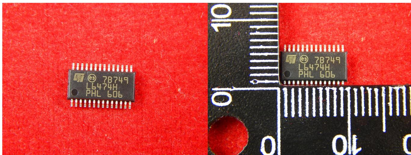
Драйвер двигателя предоставляет все необходимые спецификации отвечающие требованиям щеточных двигателей постоянного тока, шаговых двигателей и бесщеточных двигателей постоянного тока. Драйвер двигателя включает все функции, необходимые для эффективного управления двигателями. Работает с высокой точностью и включает в себя усовершенствованный генератор профилей движения.
