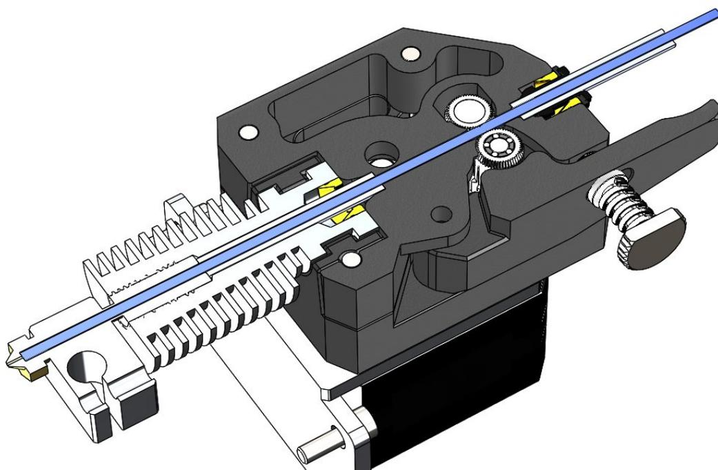
Для фиксации хотэнда используется пазовое крепление, совместимое с E3D V6 и аналогичными хотэндами, использующими стандарт GrooveMount. Масса сборки без мотора составляет 75 г.
