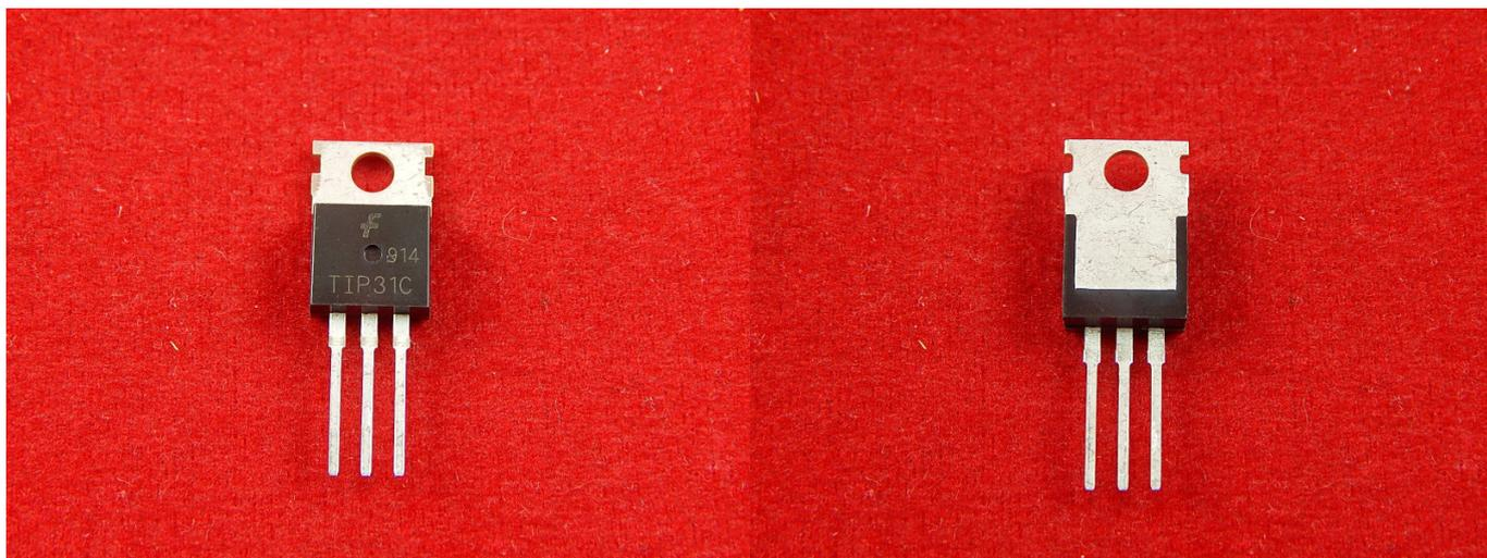
Биполярный транзистор — трёхэлектродный полупроводниковый прибор, один из типов транзисторов.
