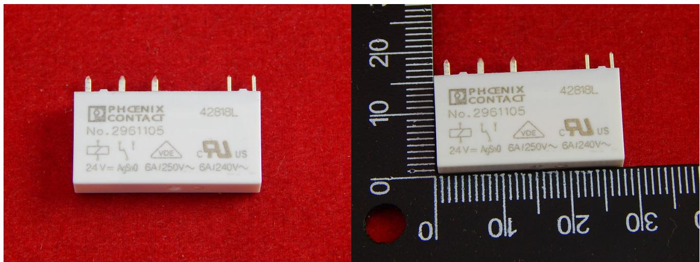
Вставное миниатюрное силовое реле с силовым контактом, 1 переключающий контакт, входное напряжение 24 В DC. Реле обладает SPDT конфигурацией контактов из серебряного оксида олова.
