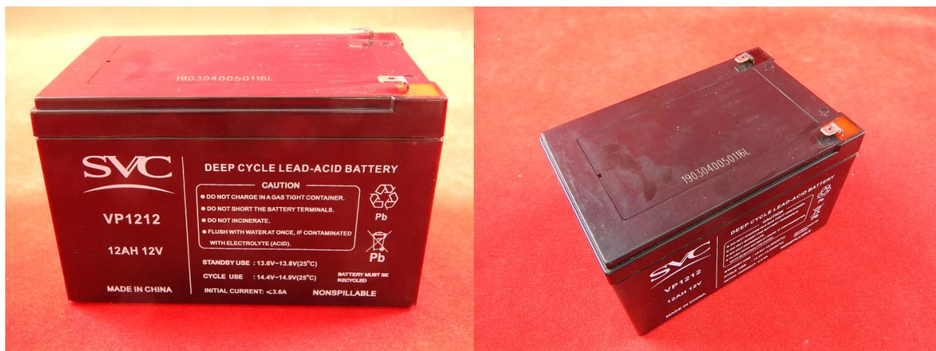
Аккумуляторные батареи (АКБ) используются в ИБП с целью накопления и использования электрической энергии для поддержания функционирования оборудования при нарушении электроснабжения от основного источника питания.
