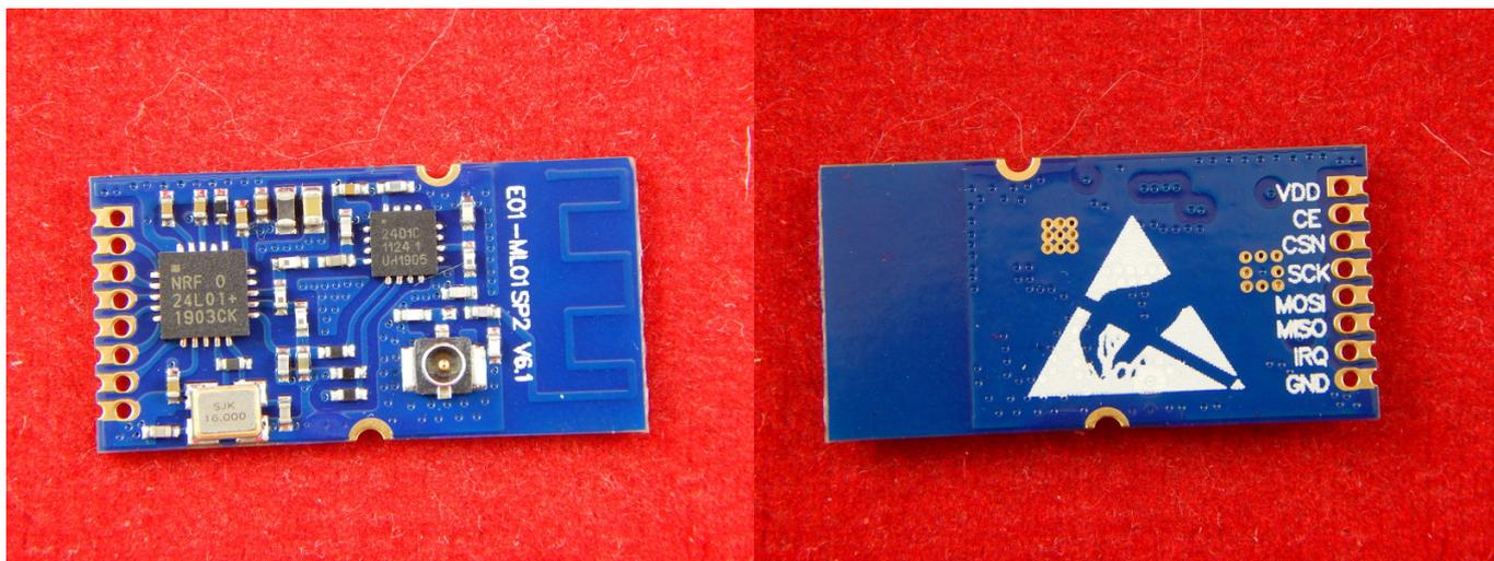
Радио-модуль (приемопередатчик) E01-ML01SP2, на базе чипа nRF24L01+, и чипа усилителя 20 дБ, что дает модулю максимальную дальность в 1800 м (на открытой местности). nRF24L01+ - отличный вариант для объединения отдаленных модулей в системе умного дома внутри помещений без прокладки проводов.
