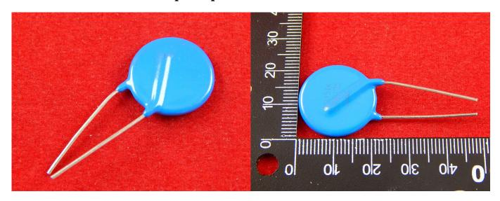
Варистор MOV20D151K изготавливается из полупроводниковых керамических материалов, состоящих в основном из оксида цинка. Он имеет нелинейное сопротивление, которое изменяется в зависимости от приложенного напряжения. Так же имеет малый размер, большую емкость тока и высокий уровень защиты.
