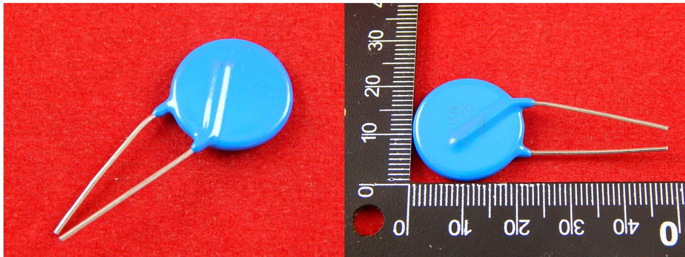
Варистор MOV20D151K изготавливается из полупроводниковых керамических материалов, состоящих в основном из оксида цинка. Он имеет нелинейное сопротивление, которое изменяется в зависимости от приложенного напряжения. Так же имеет малый размер, большую емкость тока и высокий уровень защиты.
