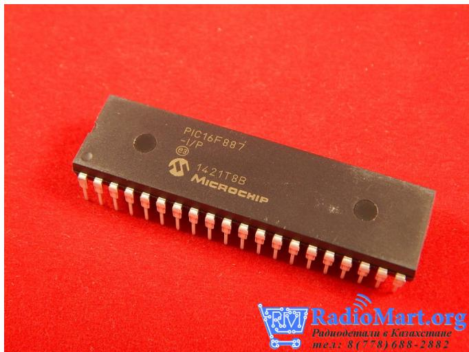
Микроконтроллер PIC16F887-I/P; EEPROM:256Б; SRAM:368Б; 20МГц; DIP40; 2÷5,5В
