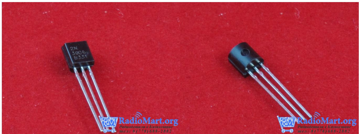
Транзистор – полупроводниковый элемент с тремя выводами (обычно), на один из которых (коллектор) подаётся сильный ток, а на другой (база) подаётся слабый (управляющий ток). При определённой силе управляющего тока, как бы «открывается клапан» и ток с коллектора начинает течь на третий вывод (эмиттер).
