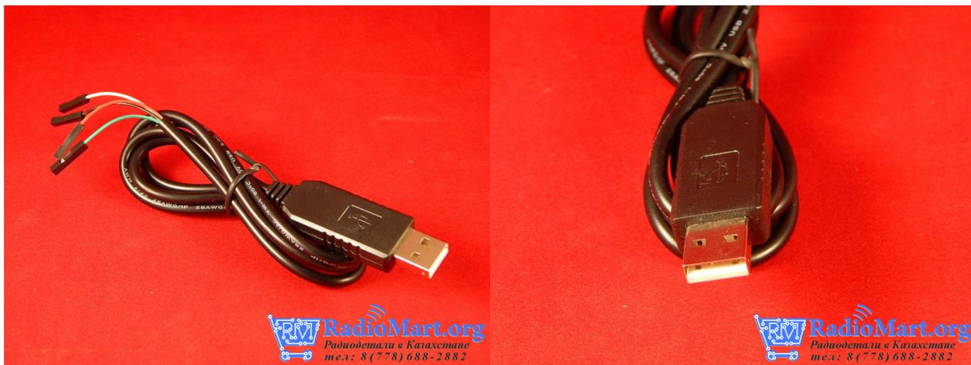
Адаптер USB - COM TTL, реализованный на базе микросхемы PL2303HX
