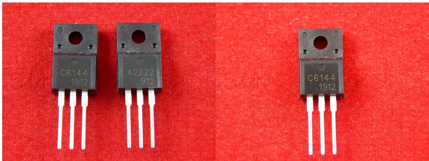
Комплементарная пара — пара транзисторов, сходных (или приблизительно сходных) по абсолютным значениям параметров, но имеющих разные типы проводимостей. Чаще всего комплементарные пары применяются в усилительных каскадах различного назначения для усиления противоположных полупериодов напряжения (например в оконечных каскадах УМЗЧ), а также в различных схемах составных транзисторов.
