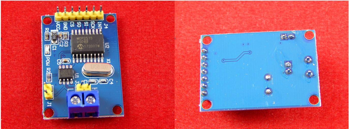
MCP2515 – это основной контроллер, который состоит из трех основных подкомпонентов: модуля CAN, логики управления и блока SPI. Модуль CAN отвечает за передачу и прием сообщений на шине CAN. Логика управления управляет настройкой и работой MCP2515, взаимодействуя со всеми блоками. Блок SPI отвечает за интерфейс связи SPI.
