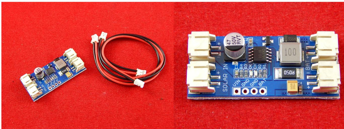
MPPT — это один из способов использования ресурсов источника энергии, в данном случае используется солнечная панель. Его основная особенность — повышение эффективности работы альтернативного источника, путём «вытягивания» максимального количества энергии за счет выбора определенного напряжения и тока.
