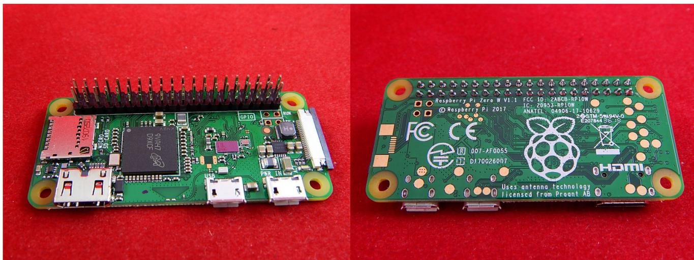
**Raspberry Pi** – одноплатный компьютер, то есть различные части компьютера, которые обычно располагаются на отдельных платах, здесь представлены на одной.
