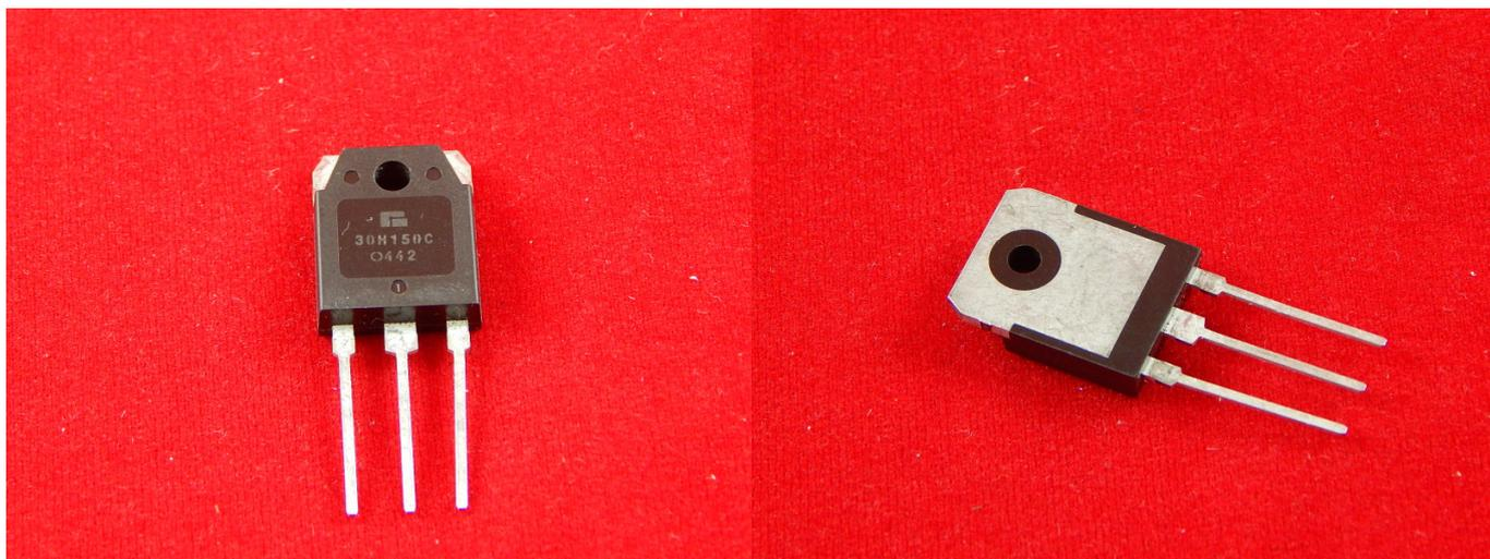
Транзистор — радиоэлектронный компонент из полупроводникового материала, обычно с тремя выводами, способный от небольшого входного сигнала управлять значительным током в выходной цепи, что позволяет использовать его для усиления, генерирования, коммутации и преобразования электрических сигналов.
