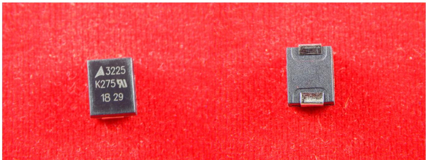
Варистор — полупроводниковый резистор, электрическое сопротивление которого нелинейно зависит от приложенного напряжения, то есть обладающий нелинейной симметричной вольт-амперной характеристикой и имеющий два вывода.
