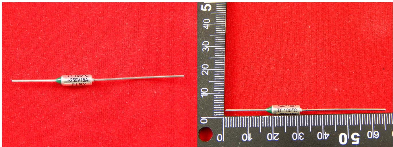
Термопредохранители служат для защиты различных электрических и электронных цепей от перегрузки по току и перегрева.
