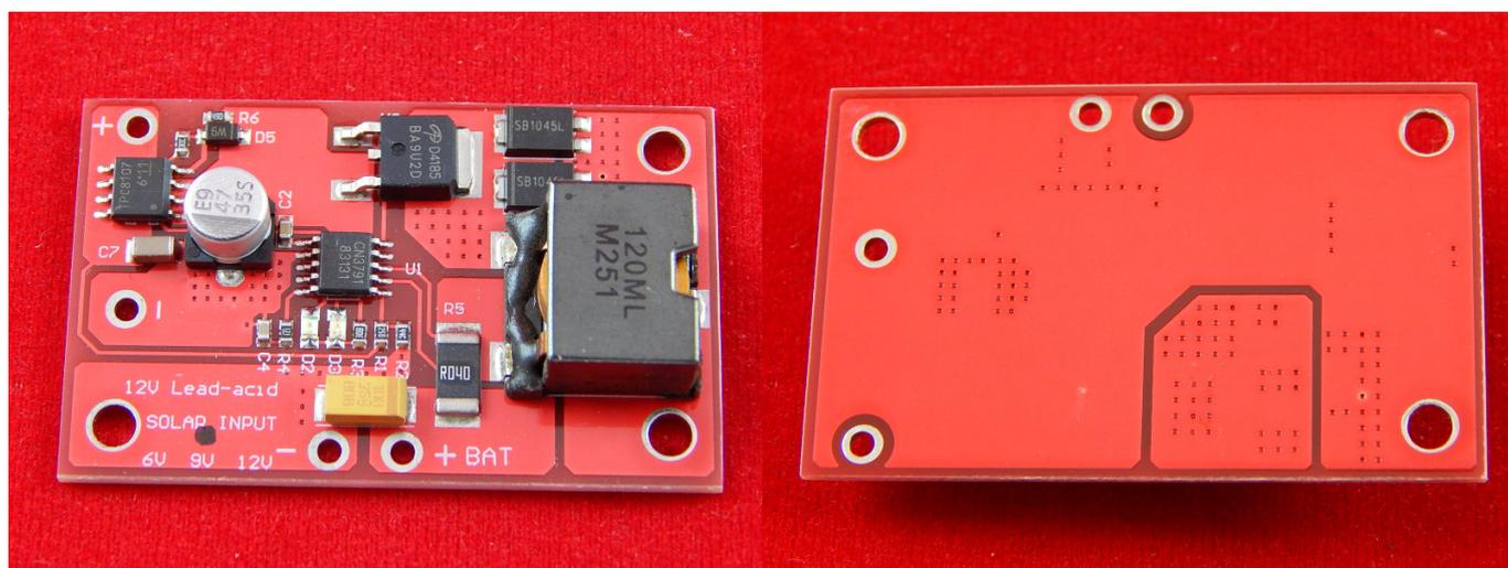
Контроллер солнечной панели — это одна из важнейших частей солнечной электростанции, отвечающая за контроль зарядного напряжения аккумулятора, режима зарядки и прочих параметров.
