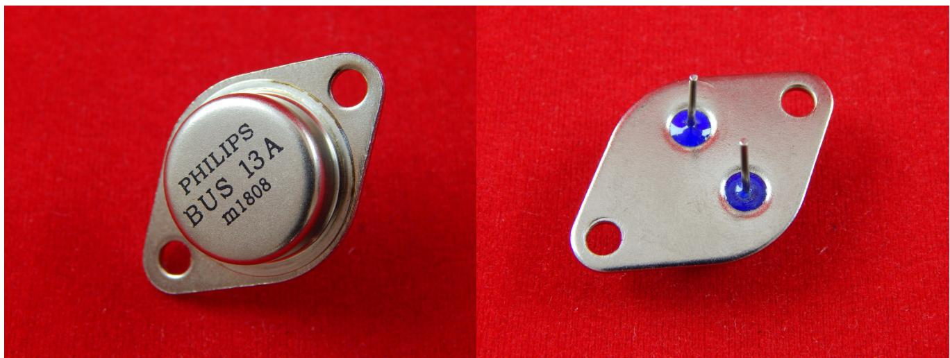
Транзистор — радиоэлектронный компонент из полупроводникового материала, способный от небольшого входного сигнала управлять значительным током в выходной цепи, что позволяет использовать его для усиления, генерирования, коммутации и преобразования электрических сигналов.
