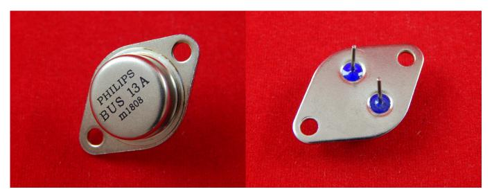
Транзистор — радиоэлектронный компонент из полупроводникового материала, способный от небольшого входного сигнала управлять значительным током в выходной цепи, что позволяет использовать его для усиления, генерирования, коммутации и преобразования электрических сигналов.
