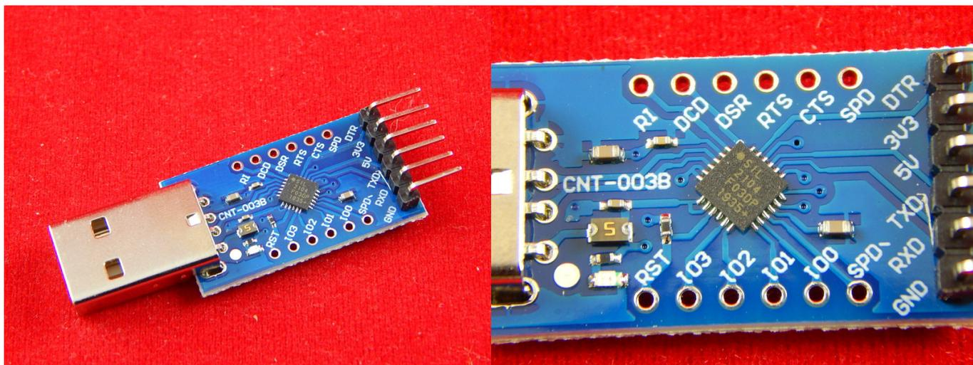
Данный модуль необходим для программирования различных Arduino контроллеров, а так же простых контроллеров. Помогает получать информацию на компьютер со всего, что имеет последовательный интерфейс с TTL логикой.
