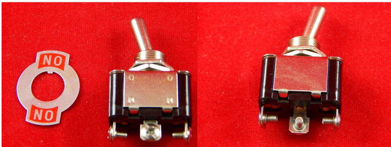
Массивный перекидной двухпозиционный переключатель может использоваться для замыкания/размыкания электрической цепи или для переключения между двумя цепями. Винты на контактах позволяют легко зажать провода. Тумблер способен коммутировать цепи с током до 15 А и напряжением до 250 В.
